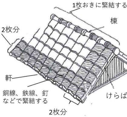
自然災害で瓦屋根被害が大きくなるのは、昔ながらの屋根葺きに見られる、土の上に瓦を乗せた工法の家屋です。土葺き施工には、重量のある屋根が滑り落ちることで災害時に家屋の倒壊を防ぐという目的もあつたようです。
