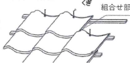
さらに平成13年からは原則として全ての瓦を緊結するガイドライン工法で建てられるようになっており、弊社が新築・葺き替えを施工させて頂いた屋根もこの工法で葺かせて頂いております。
